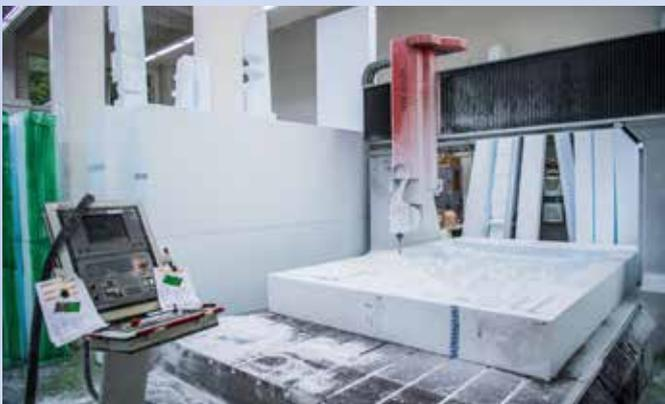
CNC-gesteuerte Fräse im Modellbau
