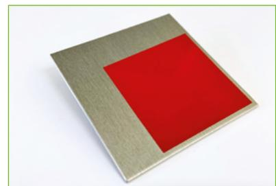
**Metallindustrie** (Blech und Aufkleber): Es handelt sich um blankes 3 mm dickes Aluminium. Die graue Seite stellt die Rückseite des Verkehrsschildes dar, auf der blanken Seite wird entweder Folie aufgezogen oder sie wird bedruckt.
