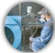
VERFAHRENSMECHANIK FÜR BESCHÜTTUNGSTECHNIK Beschichtung der Ventilatoren z.B. durch Lackierung
