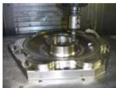
Fräsarbeiten an einer Metallform
