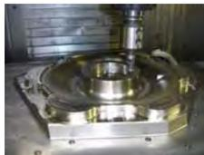
Fräsarbeiten an einer Metallform
